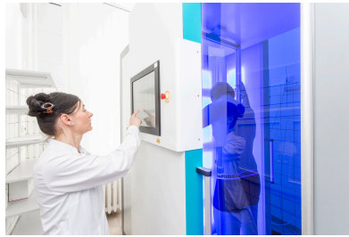
Mit dem Dermascanner wird die Hautoberfläche des Patienten aus verschiedenen Positionen gescannt und in rund 100 Einzelbilder unterteilt. © Dirk Mahler, Fraunhofer IFF
